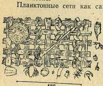
Рис. 4. Самое густое шелковое сито, употребляемое для планктонных работ, под микроскопом. Виден характер плетения нитей и организмы микропланктона.
