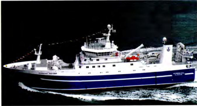
Рис. 3. Построенный в Чили норвежский траулер-сейнер может работать тралом и кошельковым неводом. Длина 83 м. Производство мороженой продукции 250 т/день. Объем трюмов: для мороженой продукции - 2680 м³, для рыбной муки – 1000 м³.
