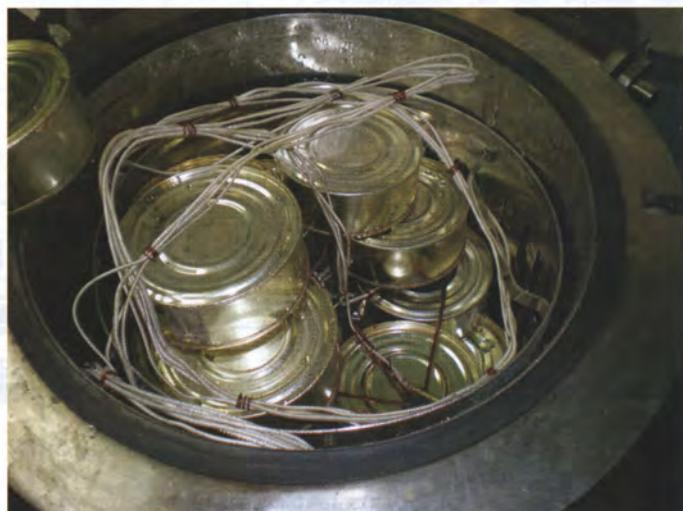
Рис. 2. Загрузка балластных банок и датчиков температуры в стерилизационную камеру
