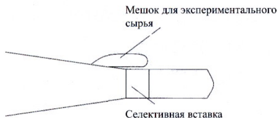
Рис. 2. Место крепления на трале мешка для экспериментального сырья
