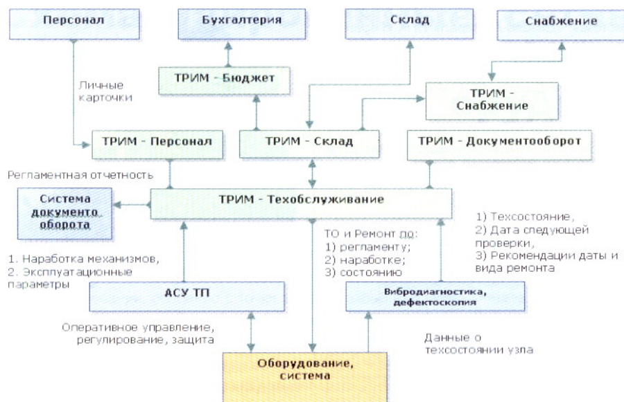
Рис. 1. Структурная схема компьютерной системы планирования и организации технического обслуживания и ремонта судов «ТРИМ»
