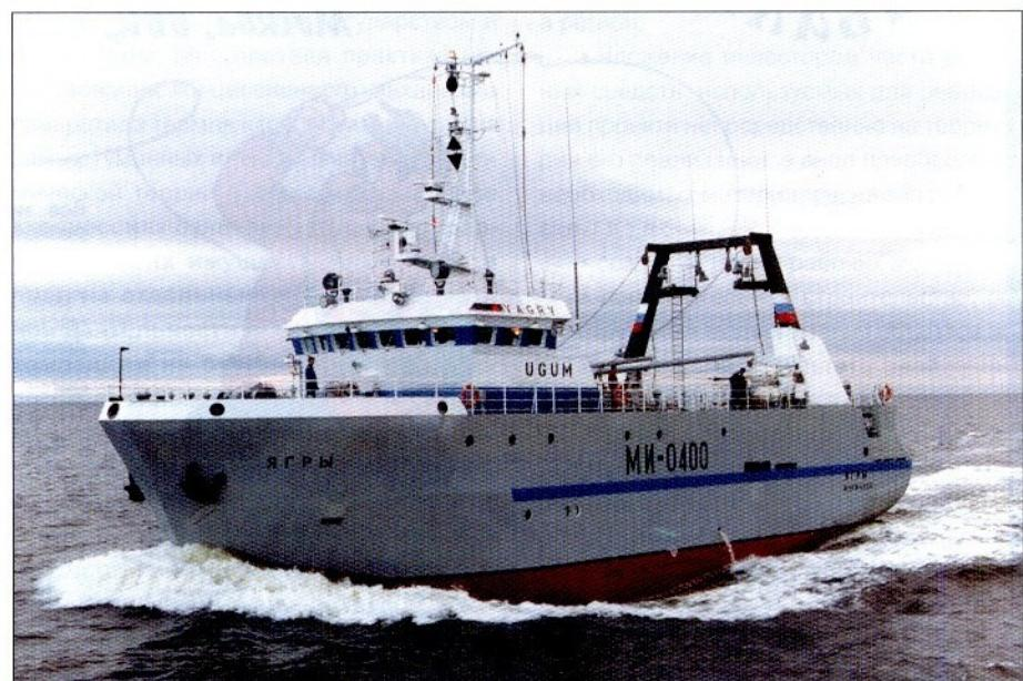
Выбрана оптимальная компоновка. Обводы и размерения судна спроектированы с учетом метеоусловий и длины волны Баренцева моря, что обеспечивает исключительную мореходность этого небольшого траулера; подобраны экономичная пропульсивная установка, оптимальная рыбфабрика. Специалистами «Грумант Флот» специально для данного судна было спроектировано эффективное промысловое снаряжение.
