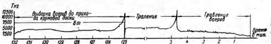
Рис. 6. Диаграмма нагрузок на ваерах за полный цикл работы с тралом
