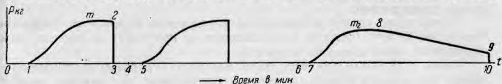
Рис. 5. Обобщенная динамограмма процесса спуска пятного крыла.
